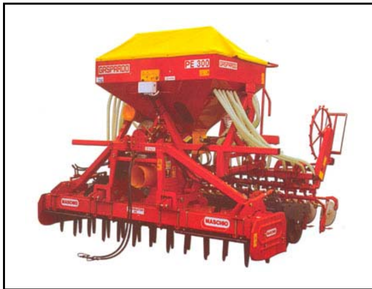
شکل ۸- کمبینات، ترکیبی از ادوات خاک‌ورز و کاشت.
