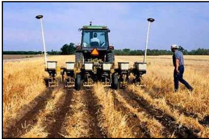
شکل ۵- کارندهایی با منضعات خاک‌ورز برای کشت بر روی پشته.
