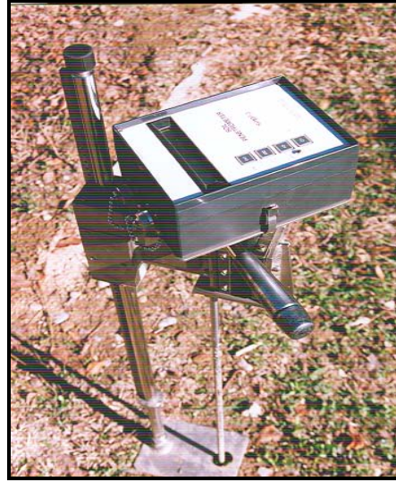
شکل ۲- دستگاه نفوذ سنج مخروطی
